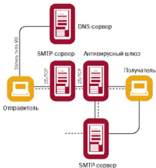
Рис.2 Схема с использованием антивирусного шлюза.
