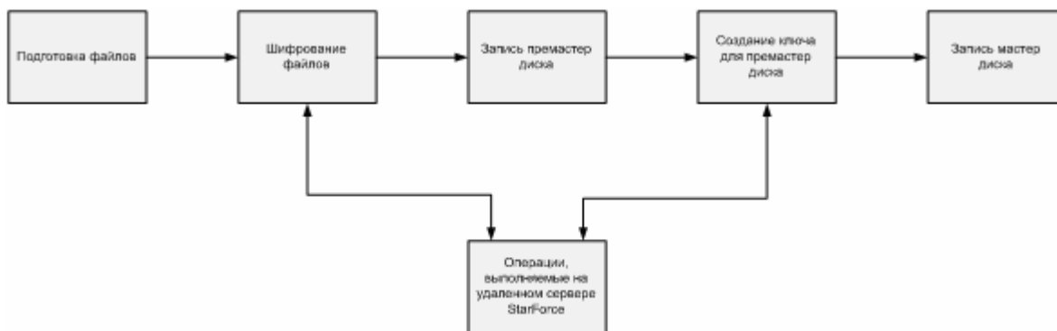
Рис. 3. Схема создания защищенного диска с помощью StarForce
