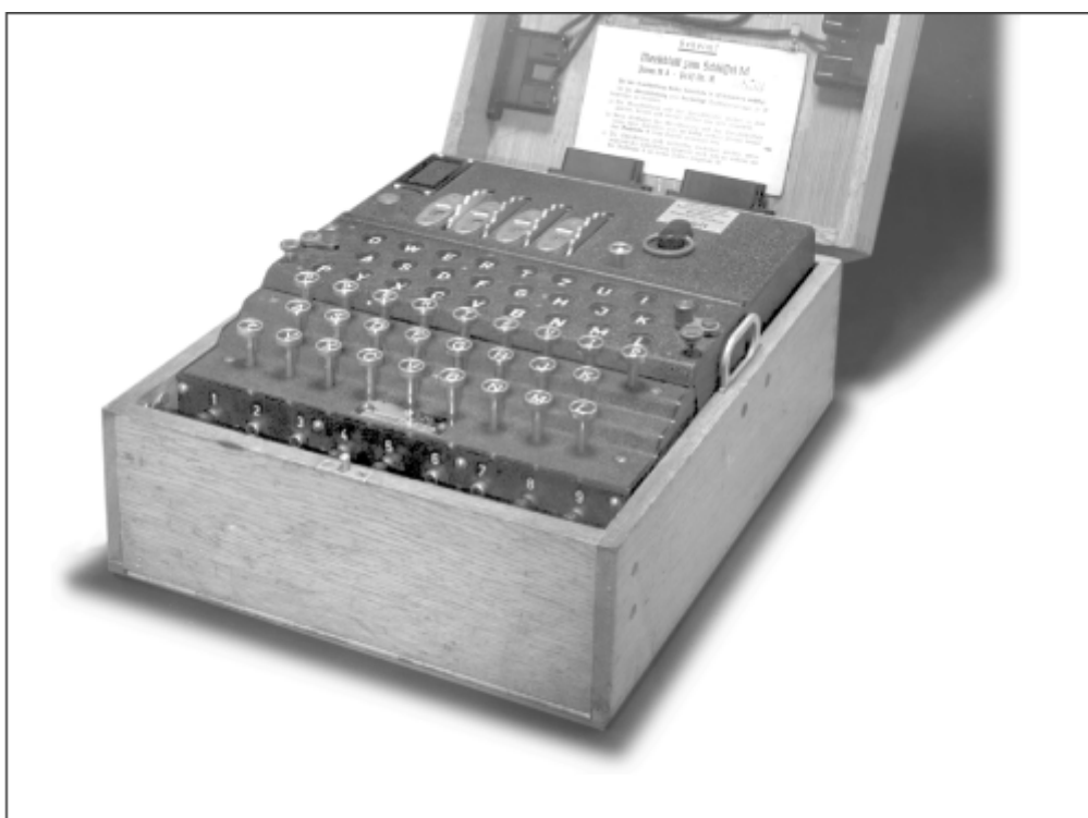
Рис 1. Немецкая шифровальная роторная машина Enigma.
